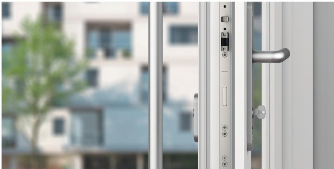
Roto Safe A es el sistema de cierre múltiple mecánico-automático en el que los cierres adicionales, así como el pestillo central de la cerradura principal, se despliegan automáticamente al cerrar la puerta. A continuación, el usuario también puede bloquear el sistema con una llave.
