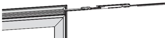
3. Conectar el ángulo de cambio con la pletina de conexión e introducir desde arriba del lado de cierre en el canal de la hoja.
